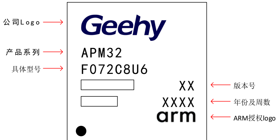
图 27 QFN48 打码规范
